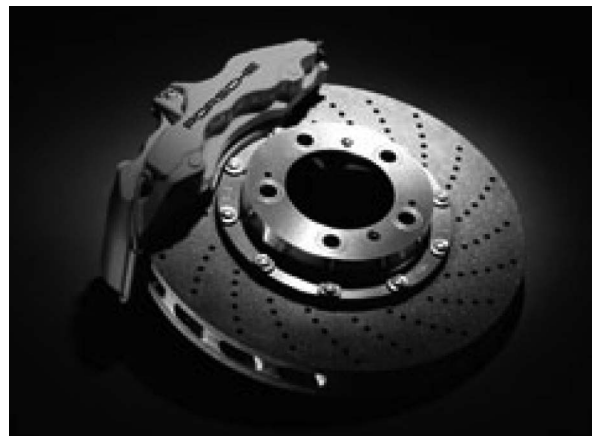
Fig. 10. (주)테크에서 개발하고 있는 자동차용 C/SiC 브레이크 디스크 부품 예.
