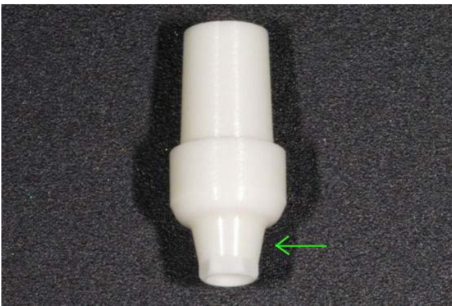
그림 5. Internal conical connection 임플란트의 지르코니아 지대주는 일반적으로 임플란트 fixture 내부에 들어가는 부분(화살표)의 두께가 두껍지 못하다. 국내 회사(덴티움, 오스템 등)에서 제작하는 internal conical connection 임플란트는 대부분 굵은 직경의 임플란트라 하더라도 fixture 내부의 지대주와 맞물리는 연결 부위의 직경이 넓지 않으므로, 지르코니아 지대주를 사용할 때 특히 조심해야 한다.
