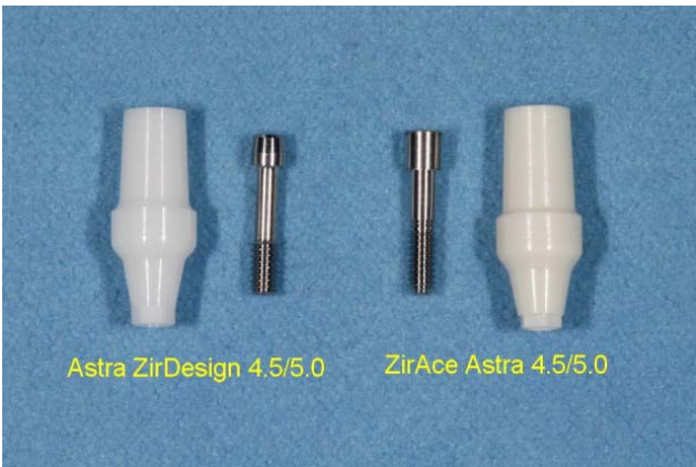
그림 15. 이 그림의 왼쪽 지대주는 3Y-TZP 성분의 지르코니아 지대주(ZirDesign, AstraTech)이고, 오른쪽은 지르코니아-알루미나 복합 세라믹 지대주(ZirAce abutment, 신원치재)이다. 복합 세라믹 지대주의 색깔이 치아의 색과 더 비슷하다.
