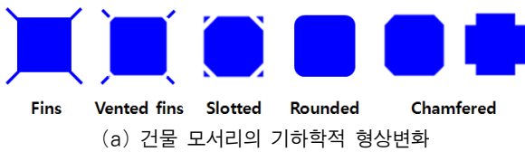
(a) 건물 모서리의 기하학적 형상변화
