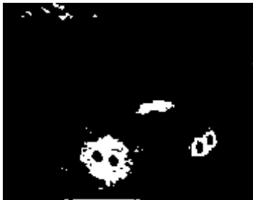
그림 2 그림 1의 입력 영상과 기준 배경 영상간의 차 영상 Fig. 2. Difference image between the reference background image and the input image in Fig. 1.
