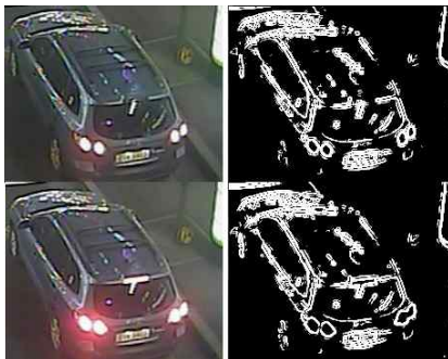
그림 1. 조명이 없을 때와 조명이 있을 때의 에지 성분 비교 Fig. 1. Comparison between edge components of an image before an artificial illumination turn on and ones after it turn on.
