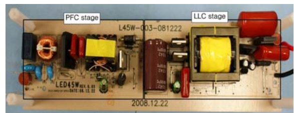
그림 10 구현된 45W LED 구동회로 Fig. 10 Implemented 45W LED Driver Circuit
