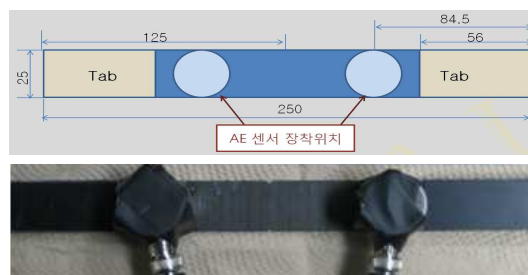
Fig. 5. 복합재 인장시편의 규격 및 센서부착위치
