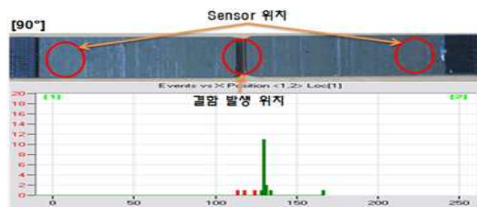
Fig 10. Matrix cracking 유도시험편 ([0°]12t) 실험 결과
