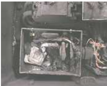
그림 2. 열폭주(Thermal runaway)에 의한 SPD 화재사진 Fig. 2. SPD burn out in thermal runaway
