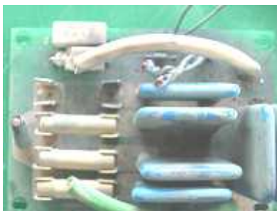
그림 3. SPD의 고장과 SPD 단로기의 파괴사진 Fig. 3. Failed surge suppressor with ruptured SPD disconnect
