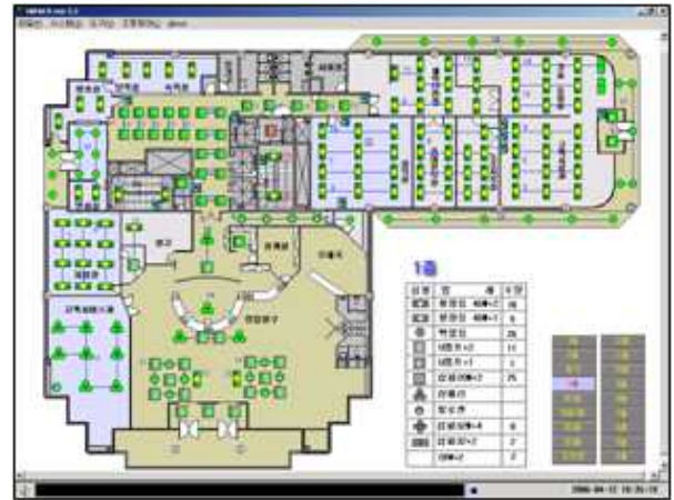
그림 12. 조명설비 화면 Fig. 12. The screen of lighting equipments
