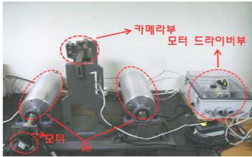
(a) 시뮬레이터의 기구부 구성 (a) The station configuration of a simulator
