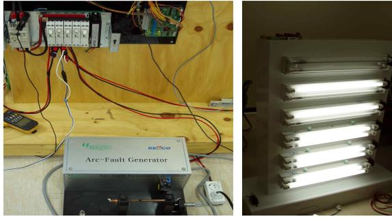
그림 3. 아크 시험 구성 및 전등 부하
