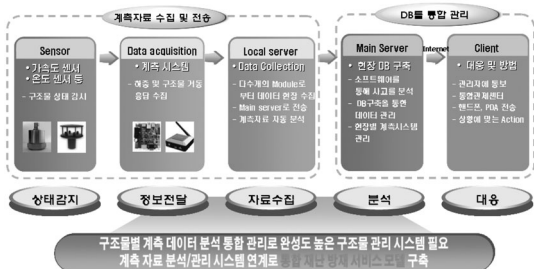
(그림 4) 센서를 통한 자료수집, 전송과 DB 통합관리 플랫폼 구성도
