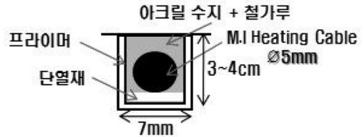
(그림 3) 최적 용설 시스템 단면도
