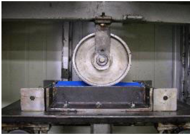
그림 6. Wheel tracking test system
