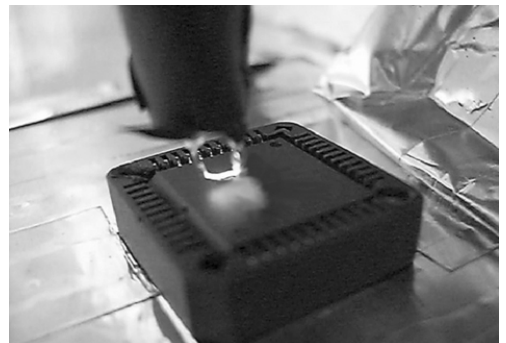
(그림 2) 마이크로 컨트롤러의 표면에 작용하는 스파크
