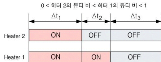
[그림 6] 듀티 비에 따른 시뮬레이션 시간 간격 및 히터 상태
