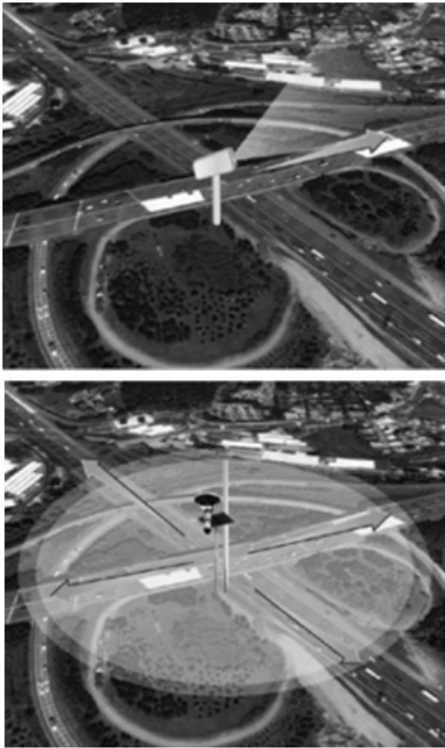
〈그림 1〉 기존 CCTV와 OSCA의 영상 범위 개요도
