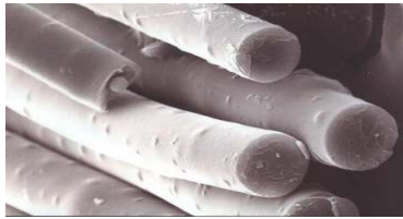
<그림 4> 원사표면에 항균 물질이 고착된 모습
