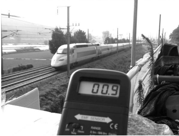
그림 2. 고속열차 객실 내부 및 레일 옆 12m, 지상고 1m에서 자기장 측정
