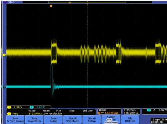
그림 7. RF 단에서 출력되는 Analog 신호. Picture 7. Analog Signal at RF Stage.
