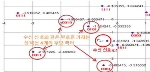
그림 5. 같은 부호를 가지는 후보 벡터를 선택하는 방법 Fig. 5 Selecting candidate vectors using same sign.
