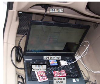
그림 2. 시스템 설치 Fig. 2 System Installation
