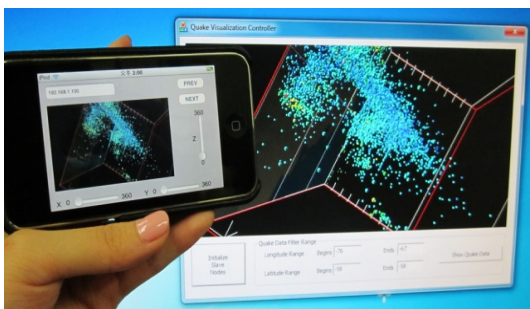
그림 4. 아이폰 입력 컨트롤러(왼쪽)와 데스크톱 입력 컨트롤러(오른쪽) Fig. 4 iPhone Input Controller (left) and Desktop Input Controller (right)
