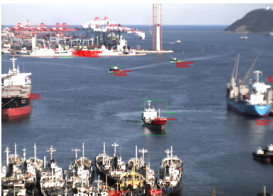
그림 6. AIS연동한 선박검출 및 선박정보 표시화면 Fig. 6. Scene for ship detection interworked with AIS
