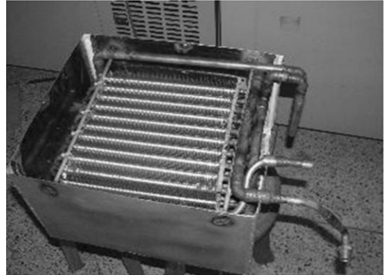
b) Aluminum Fin-tube, Size : 400(L)×350(W)×250(H)
