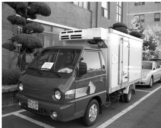
[그림 3] 열저장 장치를 이용한 수송용 냉동탑차
