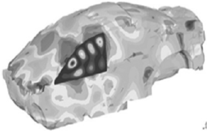
그림 11 사이드윈도우와 차량의 내부 음향공간을 고려한 Vibro-Acoustic 모델
