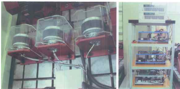
그림 6 In-Wheel Motor의 가속수명시험 [장소: KIMM] Fig. 6 Accelerated Life Test for In-Wheel Motor
