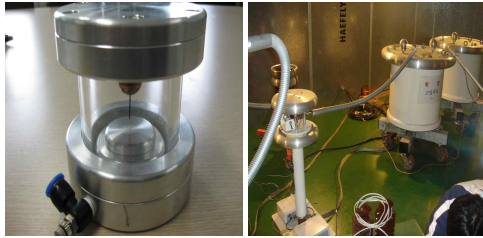
그림 5. 부분방전 셀 및 전압 인가 장치 사진. Fig. 5. Partial discharge cell and voltage application device.
