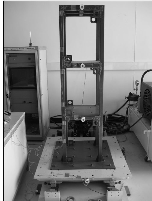
〈그림 3〉 진동대에 설치된 시편 및 계측기 부착
