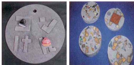
사진 8. 사철을 혼입한 콘크리트 간판
