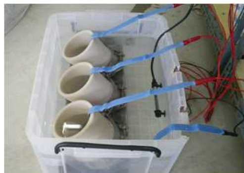
사진 4. 콘크리트 염해저항성 실험 (NTbuild 492)
