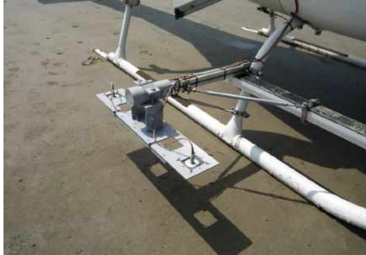
그림 7. 헬기 탑재 운용 시험의 구성 Fig. 7. Composition of helicopter operating test.
