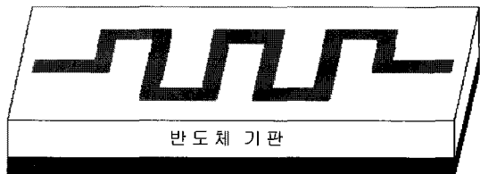
그림 13. 반도체 기판상에 제작된 미앤더라인 인덕터.
