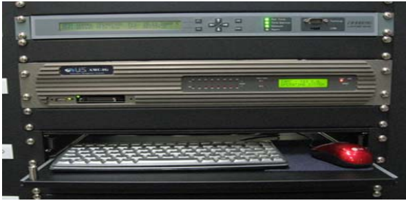
그림 3 제작되어진 게이트웨이(AMC-1G) 시제품 Fig. 3 The proto type of gateway(AMC-1G)
