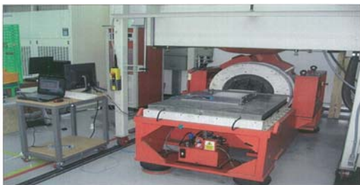
그림 7 진동시험을 위한 시제품 설치 사진 Fig. 7 The picture for the vibration test(x-axis)
