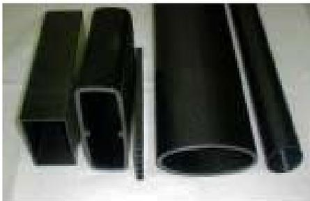
Fig. 1. CFRP pipe.
