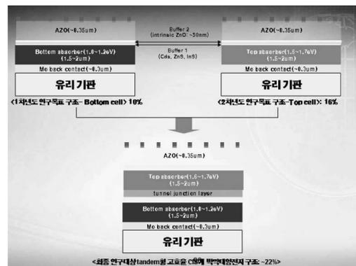
Fig. 12. 고효율 Tandem 구조를 갖는 CIS계 박막태양전지 구조 및 개발 계획.
