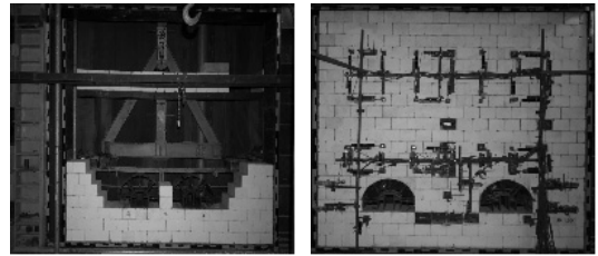
(a) 지반조성/굴착장치 설치
