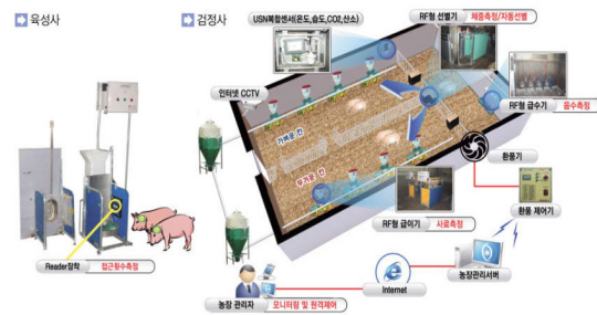
그림 2. u-양돈 사양관리 시스템 Fig. 2 u-Swiny raising management system
