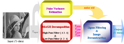
그림 2. 모디파이드 시그마 필터를 이용한 노이즈 리덕션의 전체 흐름도 Fig. 2 Block diagram of NR with MSF
