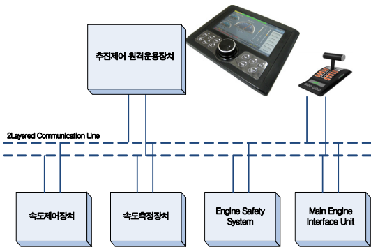
그림 2. 원격운용장치 기본 블록도 Fig. 2 Remote Operation Control System Basic Block Diagram
