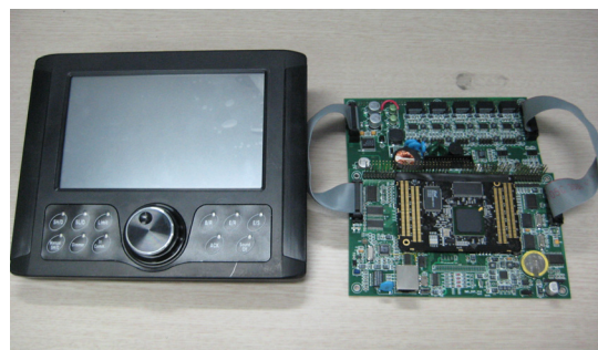
그림 8. 원격운용장치 하드웨어 Fig. 8 Remote Operation Control System
