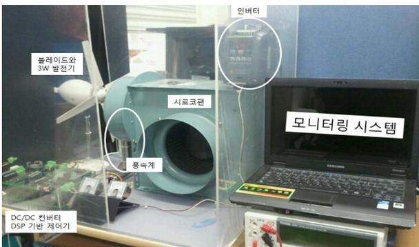
그림 12. 제작된 풍력발전기 실험 장비
