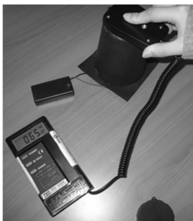
[그림 4] 외부 빛을 차단하고 조도계를 이용하여 LED의 조도를 측정하는 모습
