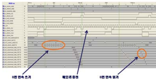
그림 5. SDRAM 제어기의 시뮬레이션 결과
