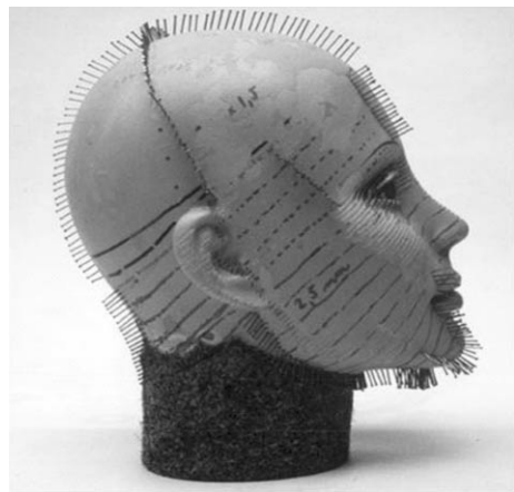
[그림 6] 피부표면 발열형 Manikin (머리부 와이어링 작업 도중)
