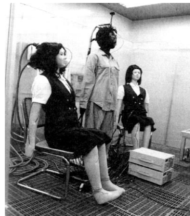
[그림 2] 흑색 Manikin과 좌식이 가능한 알루미늄 Thermal Manikin
