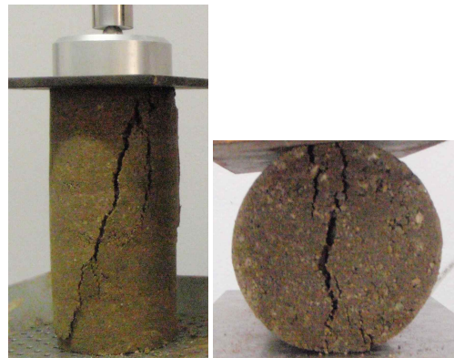
사진 1. 일축 및 인장강도시험 파괴장면(1%)
