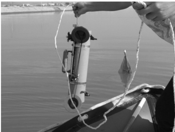
그림 8. 튜브샘플러를 이용한 상등수 샘플채취
