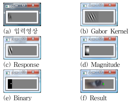
(그림 3) 가버 필터를 이용한 눈의 끝점 검출
