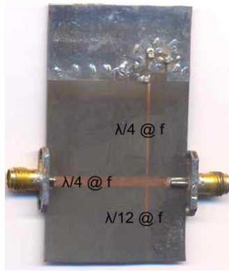
그림 4. 제작된 고조파 차단 부하 회로의 사진 Fig. 4. Photograph of the fabricated harmonic load network at 2.14 GHz.
