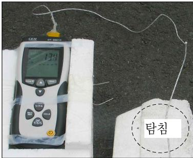
(b) 온도계를 사용한 아스팔트 온도 측정 사진
