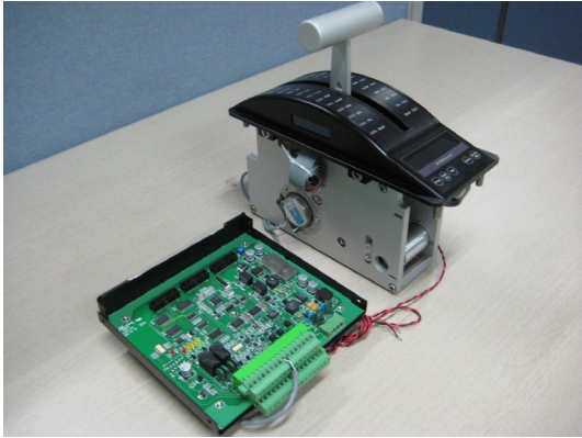
그림 6. 속도전달장치 하드웨어 플랫폼 Fig. 6 Telegraph Lever Control Unit Hardware Platform
