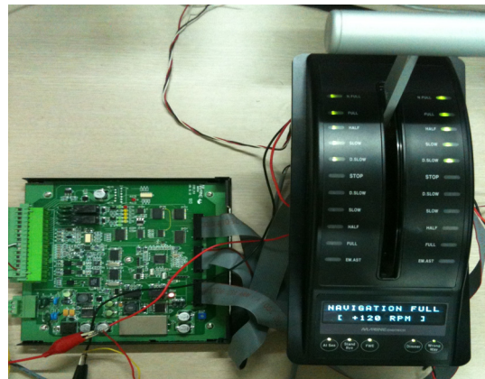
그림 9. Bridge 속도전달장치 상태 Fig. 9 Bridge Telegraph Lever Control Unit Status
