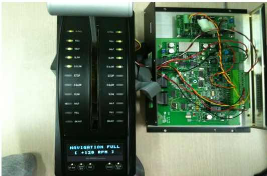
그림 11. Engine Control Room 속도전달장치 동기화 상태 Fig. 11 Engine Control Room Telegraph Lever Control Unit Synchronization Status
