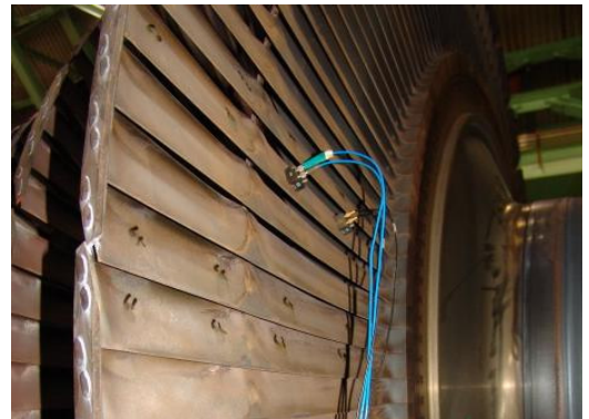
Fig. 4 Modal test for L-1 bladed-disk
